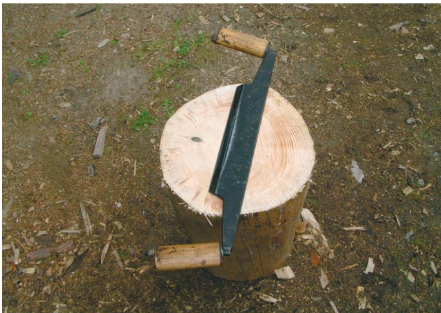
Båndkniv lavet af værktøjsstål med et stykke gevindjern som håndtag
