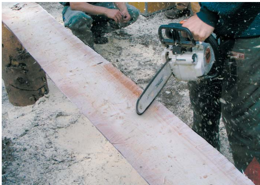
Grovpudsning med motorsav
