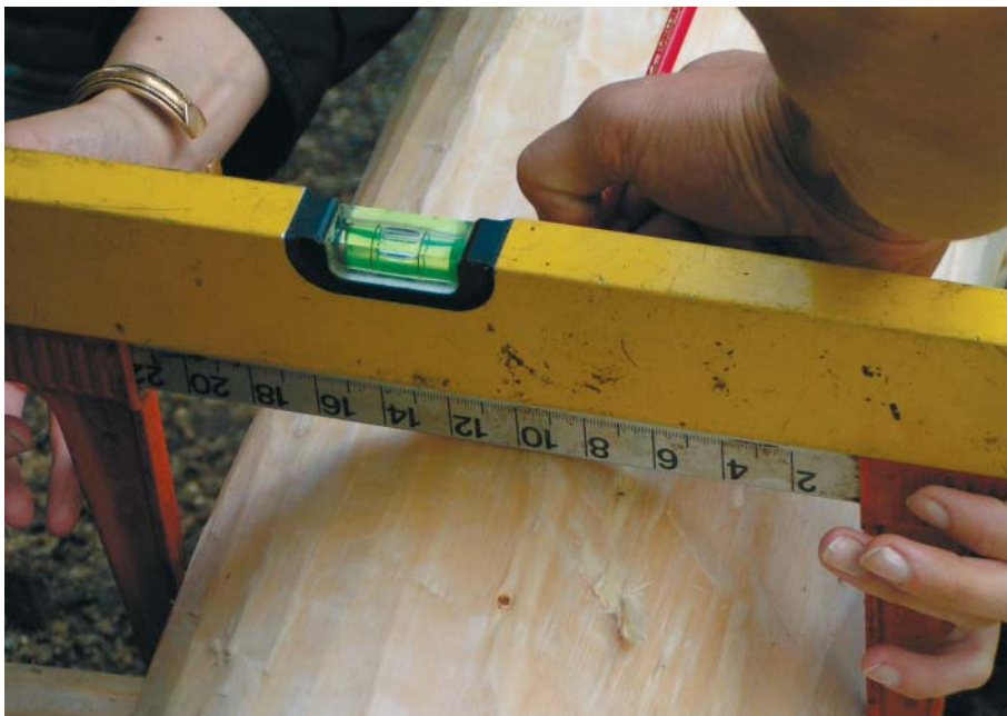
Måling af stokkens diameter
