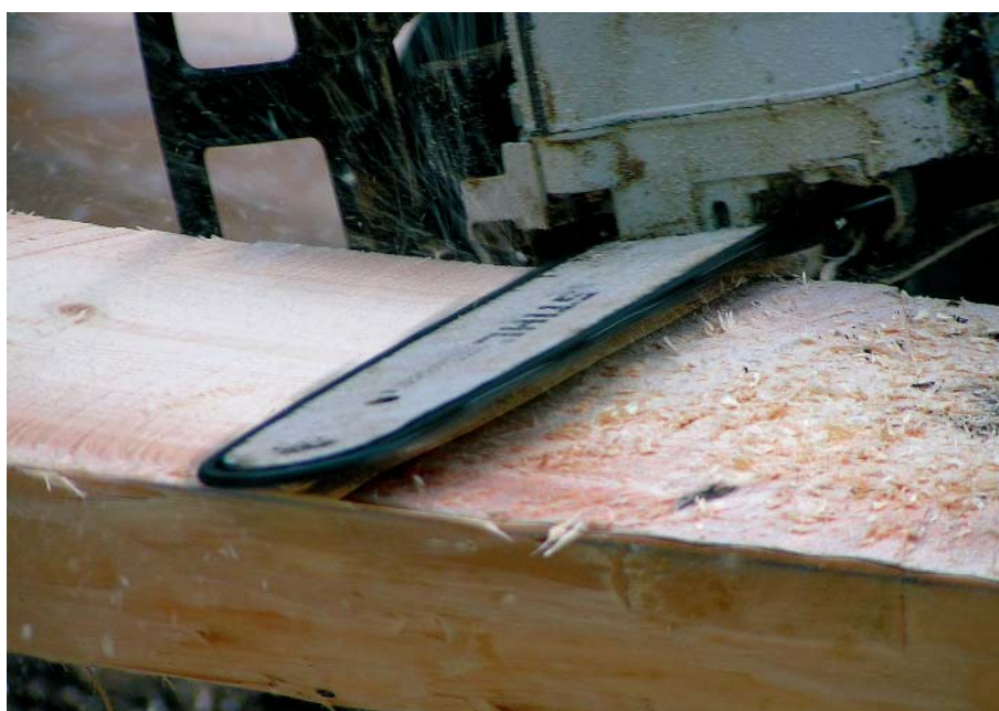
Høvling med motorsav
