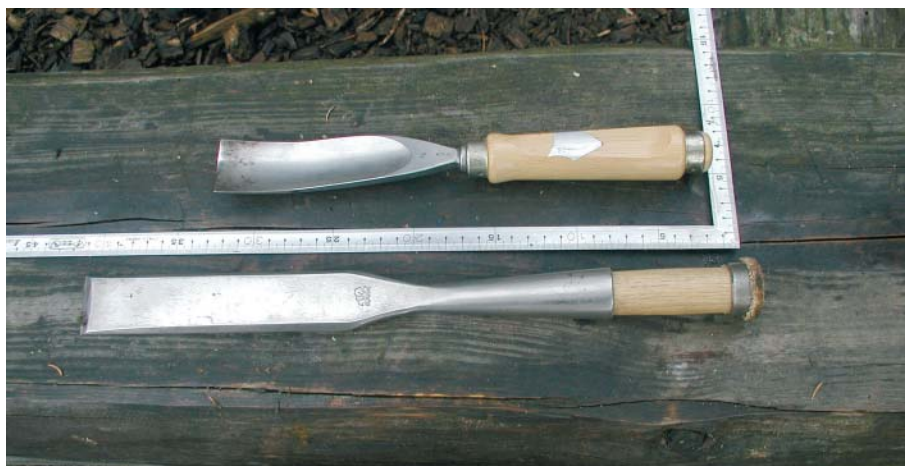
Huljern med stor hulning (øverst), tynd bøjelig tømmer stålvinde af japansk fabrikat (midten) og bredt fladjern (nederst)
